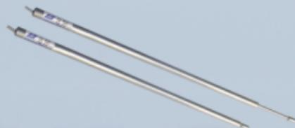
I trasduttori di spostamento lineare EDE - VXX incorporano un sensore a corda vibrante che converte lo spostamento meccanico in un'uscita elettrica in frequenza. Questa uscita può essere trasmessa su lunghe distanze. Il sensore può essere utilizzato in misuratori di crepa, estensimetri di pozzo ed estensimetri suolo, ecc. Il sensore è disponibile nelle seguenti varianti:
